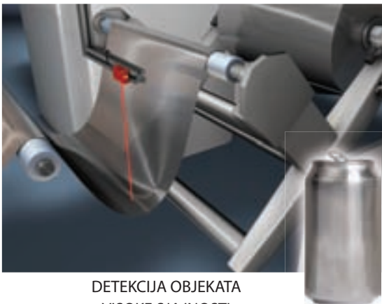
PRECIZNO MERENJE KONTURA U POKRETU
