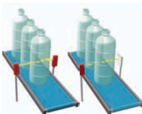
POUZDANA DETEKCIJA PROZIRNIH PET I STAKLENIH BOCA
