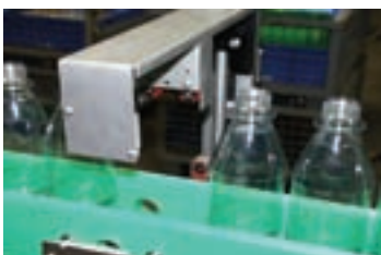
POUZDANA DETEKCIJA PROZIRNIH PET I STAKLENIH BOCA
