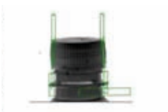
INSPEKCIJA ISPRAVNOSTI GRLA I ZATVORENOSTI ČEPA
