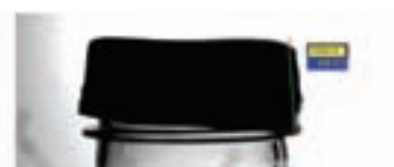
INSPEKCIJA NAKRIVLJENOSTI ČEPA
