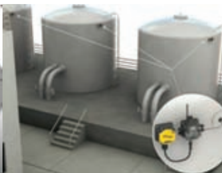
Precizno merenje nivoa u tankovima, pritiska i protoka i bežično slanje signala u jedan čvor
