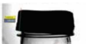
INSPEKCIJA NAKRIVLJENOSTI ČEPA
