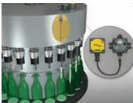
Detekcija nivoa i protoka na rotacionim punilicama boca i bežično slanje signala
