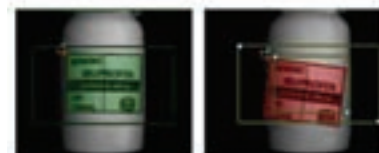
DETEKCIJA PRAVILNE POZICIJE ETIKETE
