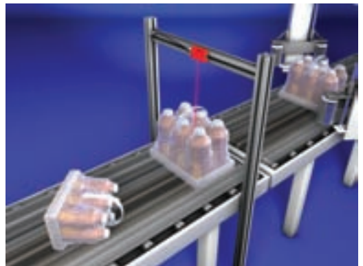
POUZDANA DETEKCIJA PAKETA BOCA OBAVIJENIH TANKOM FOLIJOM
