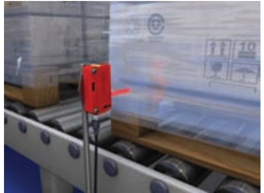
POUZDANA DETEKCIJA USTREČOVANIH PALETA
